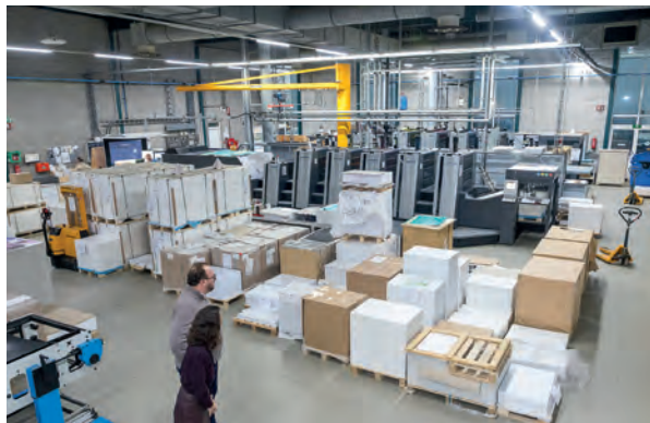
▲ De offsetdrukkerij met persen die zijn aangepast voor het bedrukken van kunststoffen. Ook signbedrijven doen soms een beroep op deze specialisatie voor het bedrukken van grotere volumes pvc-stickers.
