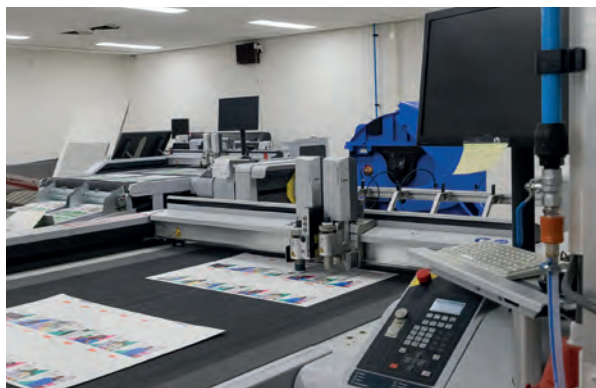
▲ Naast conventioneel stansen worden twee snijtafels van Zünd ingezet voor rillen en stansen.
